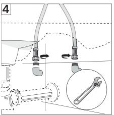
6- Conectar los flexibles a los terminales de la pared, primero con la mano, y después con la llave indicada dar un 1/4 de vuelta, tomando con la mano libre el flexible para que no se enrosque.
