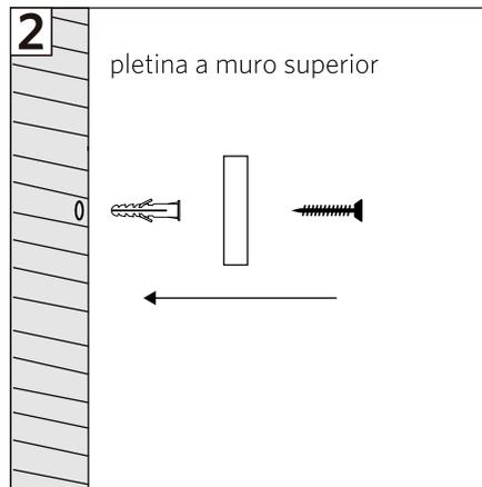
2- En la parte superior, una vez perforado el muro, instalar los tarugos, pletina y tornillos
