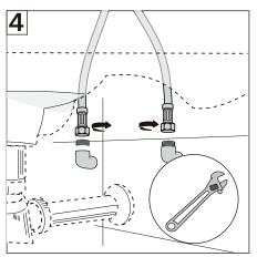
1-Conectar los flexibles a los terminales de la pared, primero con la mano, y después con la llave indicada dar un 1/4 de vuelta, tomando con la mano libre el flexible para que no se enrosque.
