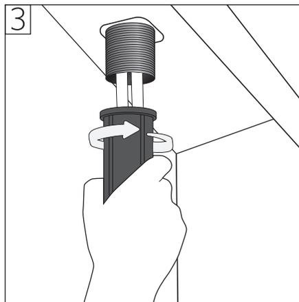
4- Por debajo del lavatorio posicionar el Fast Fix (By Stretto) y enroscar
