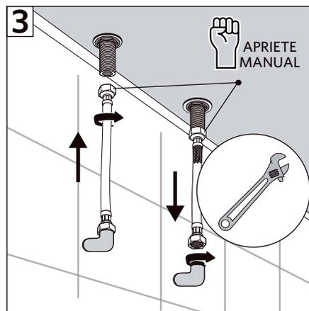
3- Ajustar firmemente los flexibles a los hilos de la grifería. Luego conectar los flexibles a los terminales de la pared, primero con la mano, y después con la llave indicada dar un 1/4 de vuelta, tomando con la mano libre el flexible para que no se enrosque.
