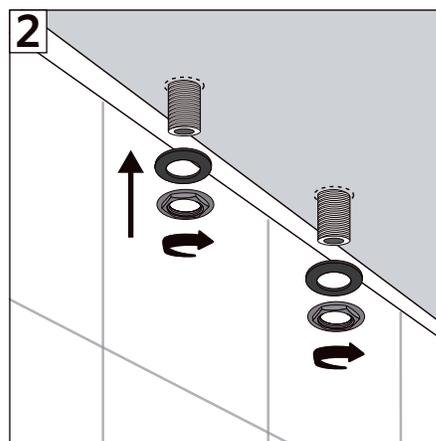
2- Por debajo del lavaplatos colocar la goma plana y la tuerca de fijación en el hilo de la grifería. Ajustar ambos componentes con la contratuerca.
