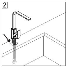
4- Posicionar la grifería en la perforación del lavaplatos introduciendo los flexibles por ella.
