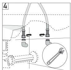
6- Conectar los flexibles a los terminales de la pared, primero con la mano, y después con la llave indicada dar 1/4 de vuelta, tomando con la mano libre el flexible para que no se enrosque.
