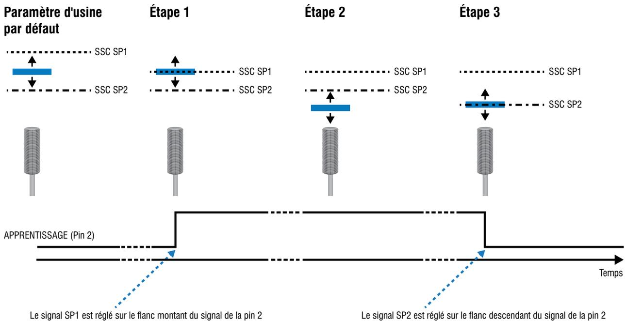
Positionner la cible au premier point de consigne et déclencher les ensembles d'impulsions d'apprentissage SP1 sur le flanc montant de l'impulsion. Repositionner la cible au deuxième point de consigne et retirer l'impulsion d'apprentissage, puis placer SP2 sur le flanc descendant de l'impulsion.
