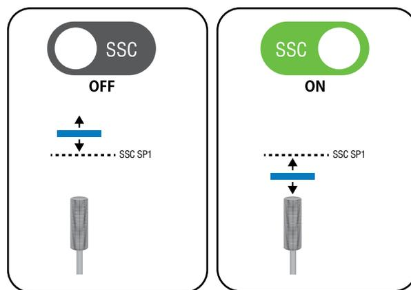
Avec le mode à point unique sélectionné, les Smart Sensors se comportent comme des dispositifs conventionnels à deux états. La logique par défaut (qui peut être inversée si l'application le demande) règle le signal de commutation sur « haut » (SSC ON), si un niveau de seuil ou un point de consigne (distance de détection, par exemple 50% de  $S_d$ ) a été atteint. De chaque côté du point de commutation, le signal passe en conséquence simplement entre « haut » et « bas ».
