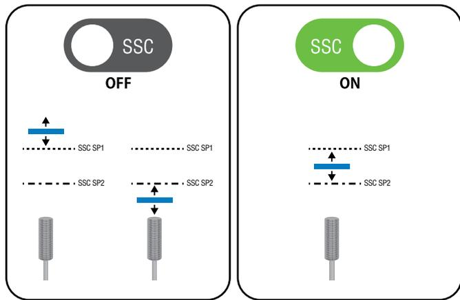
Le mode Fenêtre permet aux concepteurs de surveiller une plage de valeurs qui peuvent être définies par deux points de consigne de commutation discrets. Comme le montre l'exemple, la logique par défaut définit le signal de commutation à « haut » (SSC ON) si la valeur mesurée se trouve entre les deux points de consigne. Dans tous les autres cas, une fois que la valeur mesurée sort de la plage définie, le signal de commutation est réglé sur « bas ».
