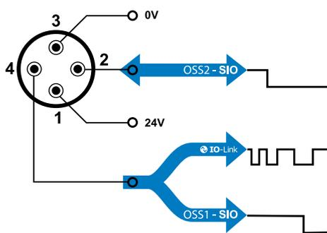
Un second SSC peut éventuellement être configuré sur le pin 2 (OSS2) du connecteur du Smart Sensor. Si activé, SSC2 fonctionne uniquement en mode SIO et peut être désigné comme canal d'entrée ou de sortie. La présence d'un deuxième canal IO permet aux utilisateurs d'accéder à de puissantes fonctionnalités supplémentaires du Smart Sensor, y compris la communication de périphérie à périphérie, les fonctions d'apprentissage et les fonctions de tests intégrées.
