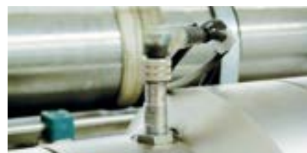
Vérins hydrauliques avec capteurs
