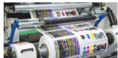
Detección de marcas de impresión en la máquina de etiquetas
