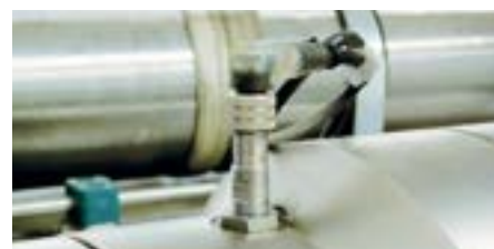
使用传感器控制液压缸
