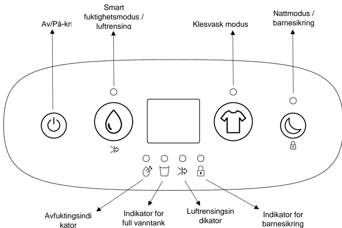
Når avfukteren første gang kobles til strømnettet, vil den pipe en gang, ingen lys vises på kontrollpanelet. Alle knappene på kontrollpanelet trenger bare et kort trykk. Trykk på knappene bestemt og raskt
