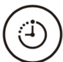
**Anschalt-Timer:** Wenn sich der Ventilator im Standby-Modus befindet, können Sie mit der Timer-Taste ein Intervall in 30-Minuten-Segmenten zwischen 1 und 6 Stunden einstellen, nach dem sich der Ventilator einschalten soll. Sobald Sie die gewünschte Stundenzahl auf dem Display erreicht haben, blinkt die Zahl viermal und ist dann eingestellt.
