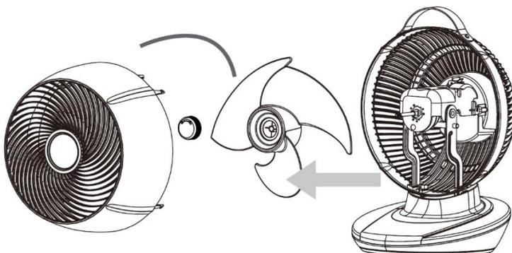
3. Pulire le pale del ventilatore e la parte interna del ventilatore con un panno morbido e asciutto. Invertire la procedura per rimontare la ventola. Assicuratevi che il tappo di bloccaggio sia ben serrato.
