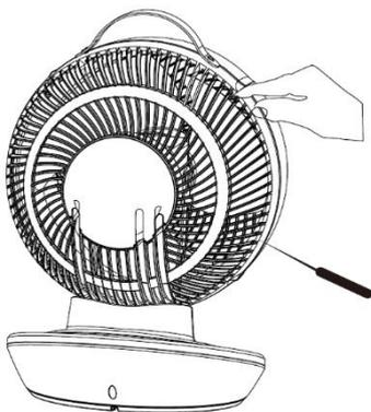
2. Con un cacciavite, svitare le due piccole viti nella parte posteriore superiore della ventola. Esse si trovano direttamente sotto le estremità della maniglia.
