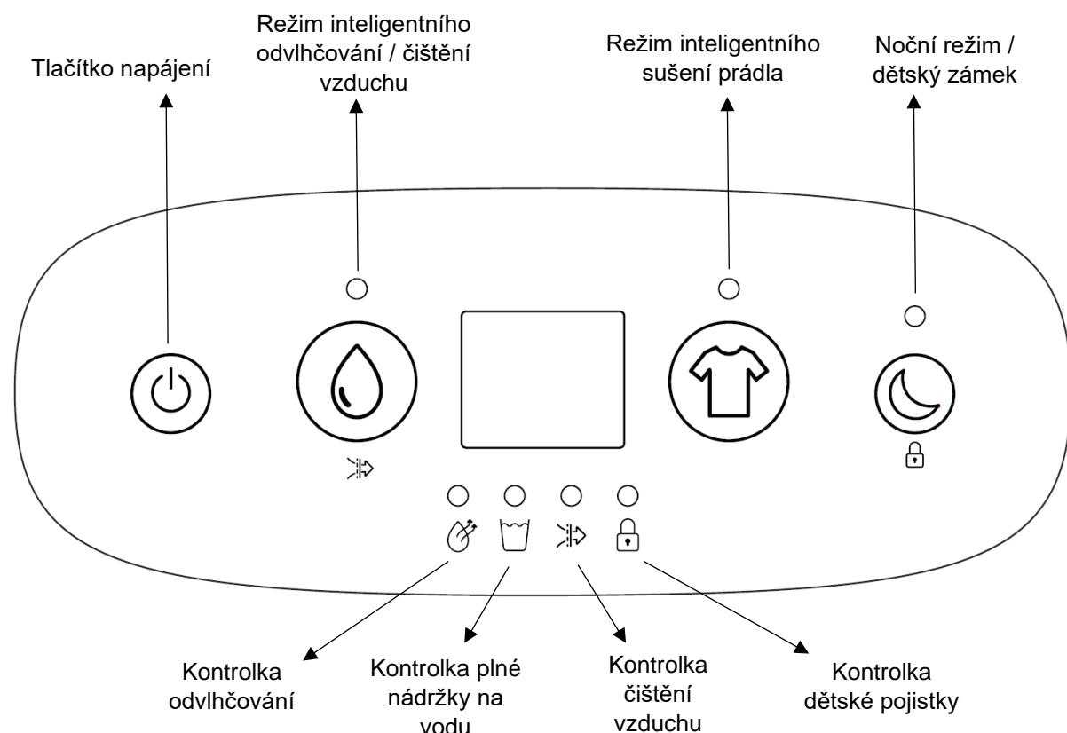
Při prvním připojení odvlhčovače k síti se ozve jedno pípnutí, na ovládacím panelu se nerozsvítí žádná
