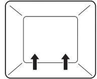
Die Beheizung erfolgt durch den unteren Heizkörper.
