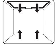
Die Beheizung erfolgt durch die oberen und unteren Heizkörper.
