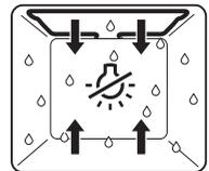
Die Beheizung erfolgt durch die oberen und unteren Heizkörper. Die entstehende Eigenfeuchtigkeit wird minimal aus dem Garraum abgeführt. Die Feuchtigkeit des Garguts bleibt erhalten.
