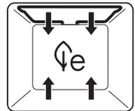
Diese Anwendung ist besonders energiesparend. Die Beheizung erfolgt durch die oberen und unteren Heizkörper. Die austretende Eigenfeuchtigkeit der Lebensmittel wird im Garraum gehalten. Das Gargut trocknet weniger aus.
