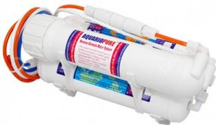
Nous conseillons [(2 cartouches pré-filtres) + 1 membrane d'osmose], ce qui est largement suffisant du fait que nous obtiendront ainsi une eau à environ 10 mg / Litre de résidu sec. Il se branche simplement sur un robinet, sans travaux de plomberie. Le raccord fileté est fourni. L'eau du réseau doit être 3,5 à 4 bar au minimum (standard).
