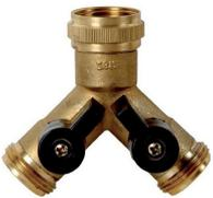
Un raccord type Y permettra de brancher simultanément la machine à laver et l'osmoseur. L'évacuation de l'eau de rejet se fait dans la canalisation d'égout de la machine à laver. Choisir un robinet Y avec robinet d'arrêt (cf photo). Pour filtrer votre eau ouvrir le robinet côté osmoseur. L'e fermer lorsque la fontaine est pleine. Il est également possible d'installer une mini vanne d'irrigation (cf photo) sur un raccord Y sans robinet..
