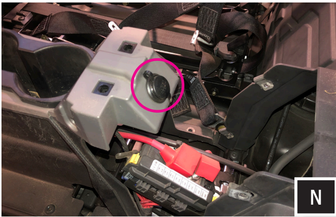
N. Disconnect the 12V socket.
