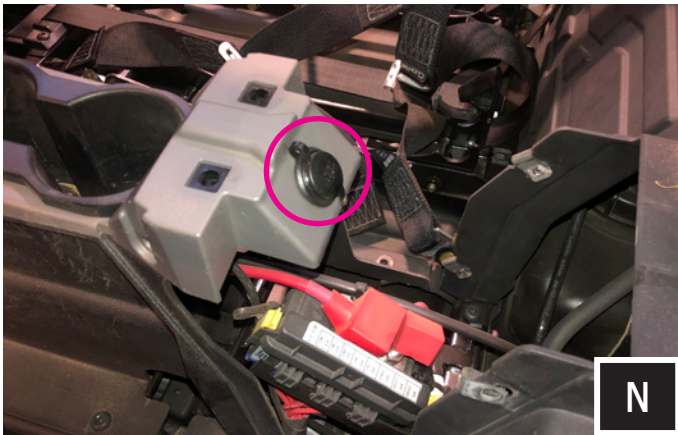
N. Disconnect the 12V socket.
