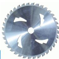
Disco decespugliatore a 36 denti con placchette in tungsteno. Larghezza di taglio 255 mm. Diametro foro 25,4 mm, spessore 2,0 mm.
