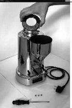
Drehen Sie die Halterung der oberen Mahlscheibe
