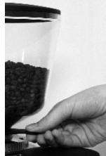
Lösen Sie die drei Schrauben der Mahlgradskala mit Hilfe eines Inbusschlüssel 2,5 mm.
