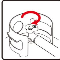
4. Si está conectado, asegúrese de que la perilla del cilindro de GLP o la válvula de la fuente de gas natural estén completamente cerrados o desconectados.
