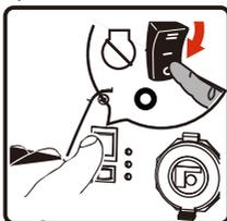
3. Gire el selector de combustible a la posición "GLP" (1:30 en punto). La válvula de gasolina está cerca de esta posición.
