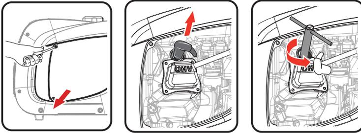
(d) Inspeccione la bujía para ver si está dañada y límpiela con un cepillo de alambre antes de volver a instalarla. Reemplace si está dañada.
