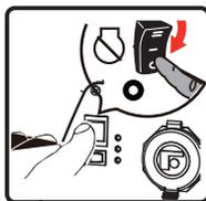
3. Gire el selector de combustible a la posición "LPG" (1:30 en punto). La válvula de gasolina está cerca de esta posición.
