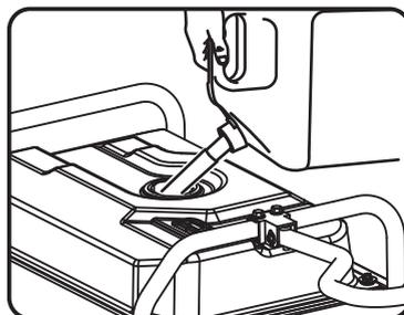
3. Coloque la tapa del combustible y deje que el combustible derramado se evapore antes de arrancar el motor.
