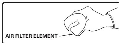
(d) Instale de nuevo el elemento filtrante de aire limpio o nuevo.
