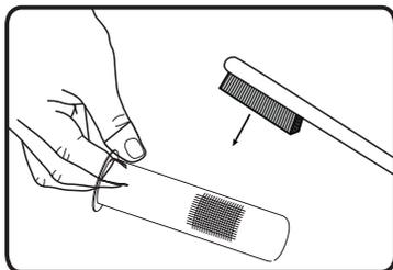
4. Reemplace el supresor de chispas si está dañado. Si se necesitan piezas de repuesto, asegúrese de usar solo partes de reemplazo del equipo originales FIRMAN.
