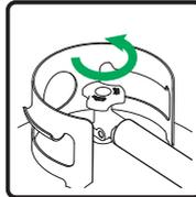
5. Si está conectado, asegúrese de que la perilla del cilindro de GLP o la válvula de la fuente de gas natural estén completamente cerrados o desconectados.
