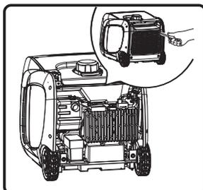
(b) Retire cuidadosamente el elemento filtrante de aire de espuma y lávelo solo con detergente líquido y agua. Exprima en un paño limpio para secarlo.
