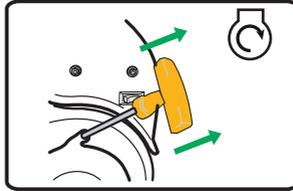
Si el motor no arranca en 1 o 2 tirones con el cebador en la posición RUN, mueva la palanca del cebador a la posición START y repita el paso TIRAR PARA CEBAR (10).
