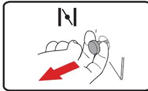
10. TIRAR PARA CEBAR Tirar de la cuerda de arranque 1 o 2 veces. Tire lentamente hasta que sienta resistencia y luego tire rápidamente.
