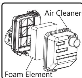
(c) Sature el elemento filtrante de aire de espuma con aceite de motor limpio y exprima en un paño limpio para eliminar el exceso de aceite.
