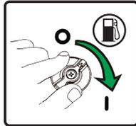
5. Coloque el interruptor del motor a la "RUN" (I).
