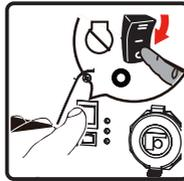
3. Pulse el interruptor del motor a la posición "OFF(O)".
