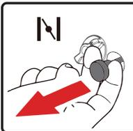
8. Tire de la cuerda de arranque lentamente hasta que sienta resistencia y luego tire rápidamente para arrancar el motor.
