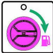
**NOTE :** Lorsque le sélecteur de carburant est en position « GAS », le témoin lumineux devient rouge pendant 4 minutes avant de s'éteindre. Si le moteur démarre pendant les 4 minutes, le voyant tourne au vert. Voir la section Témoin lumineux/Mode économie d'énergie de la batterie pour plus d'informations.
