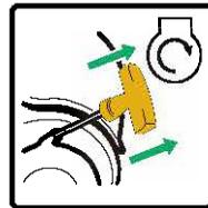
Si le moteur ne démarre pas en 2 coups avec le starter en position « RUN », mettez le levier de starter en position « START » et répétez l'étape 9.
