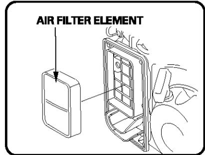
(b) Saturer l'élément en mousse du filtre à air avec de l'huile moteur propre et mettez-le dans un chiffon propre pour éliminer l'excès d'huile.
