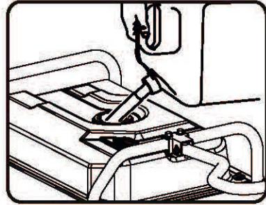
3. Mettez le bouchon de carburant et laissez le carburant déversé s'évaporer avant de démarrer le moteur.
