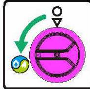
**NOTE:** Lorsque le sélecteur de carburant est en position GPL/GN, le témoin lumineux devient rouge pendant 4 minutes avant de s'éteindre. Si le moteur démarre pendant les 4 minutes, le voyant tourne au vert. Voir la section Témoin lumineux/Mode économie d'énergie de la batterie pour plus d'informations.
