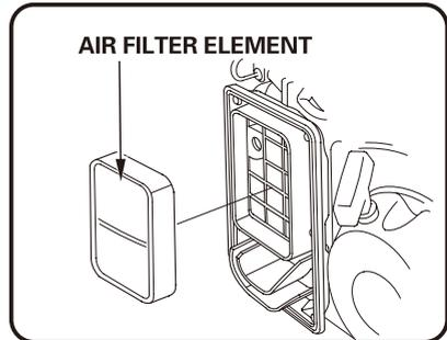
(b) Saturez l'élément en mousse du filtre à air avec de l'huile moteur propre et mettez-le dans un chiffon propre pour éliminer l'excès d'huile.
