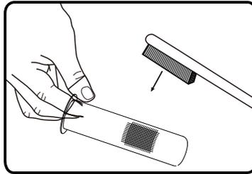
3. Remplacez le pare-étincelles si nécessaire. Si des pièces de rechange sont nécessaires, assurez-vous d'utiliser uniquement des pièces d'origine FIRMAN.
