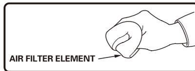
(c) Réinstallez L'élément De Filtre À Air Propre Ou Neuf.
