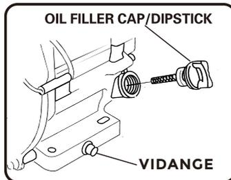
(b) Remettez le bouchon de vidange et remplissez le moteur d'huile jusqu'à ce qu'elle atteigne le niveau (H) sur la jauge d'huile.
