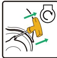
Si le moteur ne démarre pas en 2 coups avec starter en position RUN, mettez le levier de starter en position « START » et répétez l'étape 9.
