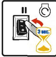
9. Ne pas trop étrangler. Dès que le moteur démarre et se réchauffe, pousser le levier d'étranglement en position « RUN ».
