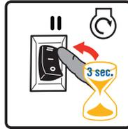
10. No cebe demasiado. Tan pronto como el motor arranque y se caliente, mueva lentamente la palanca del cebador a la posición RUN.
