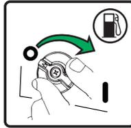
5. Mueva el interruptor del motor a la posición "RUN" (I).
