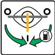
5. Appuyez sur l'interrupteur du moteur en position «ON»(I).
