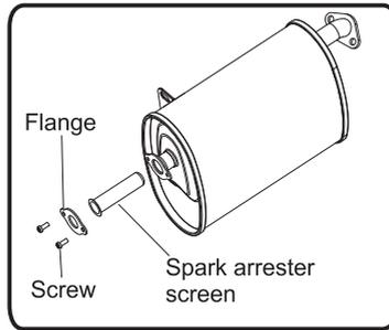
3. Retire cuidadosamente los depósitos de carbono de la pantalla del supresor de chispas con un cepillo de alambre.
