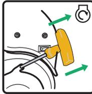
8. No cebe demasiado. Tan pronto como el motor arranque y se caliente, mueva lentamente la palanca del cebador a la posición RUN.
