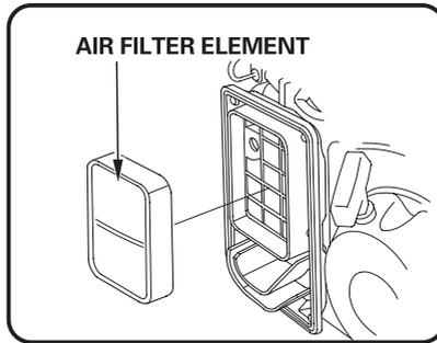
(b) Sature el elemento filtrante de aire de espuma con aceite de motor limpio y exprima en un paño limpio para eliminar el exceso de aceite.
