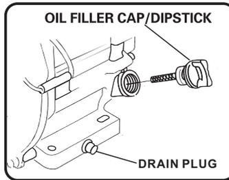
(b) Coloque nuevamente el tapón de drenaje y llene el motor con aceite hasta que alcance el nivel ALTO (H) en la varilla de llenado de aceite.
