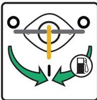
5. Mueva el interruptor del motor a la posición "ON (I)".
