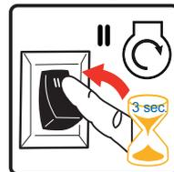
**RECORDATORIO:** LA LUZ DEL INDICADOR DEBE ESTAR DE COLOR ROJO SÓLIDO PARA PODER ENCENDER EL GENERADOR. EL GENERADOR NO SE PUEDE ENCENDER DURANTE EL **MODO DE AHORRO DE POTENCIA DE LA BATERÍA** A MENOS QUE EL INTERRUPTOR SELECTOR DE COMBUSTIBLE HAYA ESTADO EN POSICIÓN "OFF" Y LUEGO HAYA VUELTO A LA POSICIÓN "GAS".
