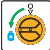
**NOTA:** Cuando el interruptor selector de combustible esté en posición "LPG", la luz indicadora se pondrá de color **ROJO** durante **4 minutos** (antes de apagarse). Si se consigue encender el motor con éxito durante estos **4 minutos**, la luz indicadora se pondrá de color **VERDE**.
