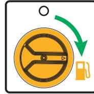
**NOTA:** Cuando el interruptor selector de combustible esté en posición "GAS", la luz indicadora se pondrá de color **ROJO** durante **4 minutos** (antes de apagarse). Si se consigue encender el motor con éxito durante estos **4 minutos**, la luz indicadora se pondrá de color **VERDE**.
