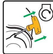
Si el motor no consigue encenderse tras 1-2 estiros con el obturador en la posición "RUN", gire la palanca del obturador hacia la posición "START" y repita el paso "ESTIRAR PARA PREPARAR".
