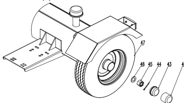
**REMARQUE** Gardez la saleté et les débris loin des roulements de roue pendant l'assemblage. Un serrage excessif de l'écrou à créneaux dégagés entraînera un fonctionnement à chaud des roulements et une défaillance prématurée.
