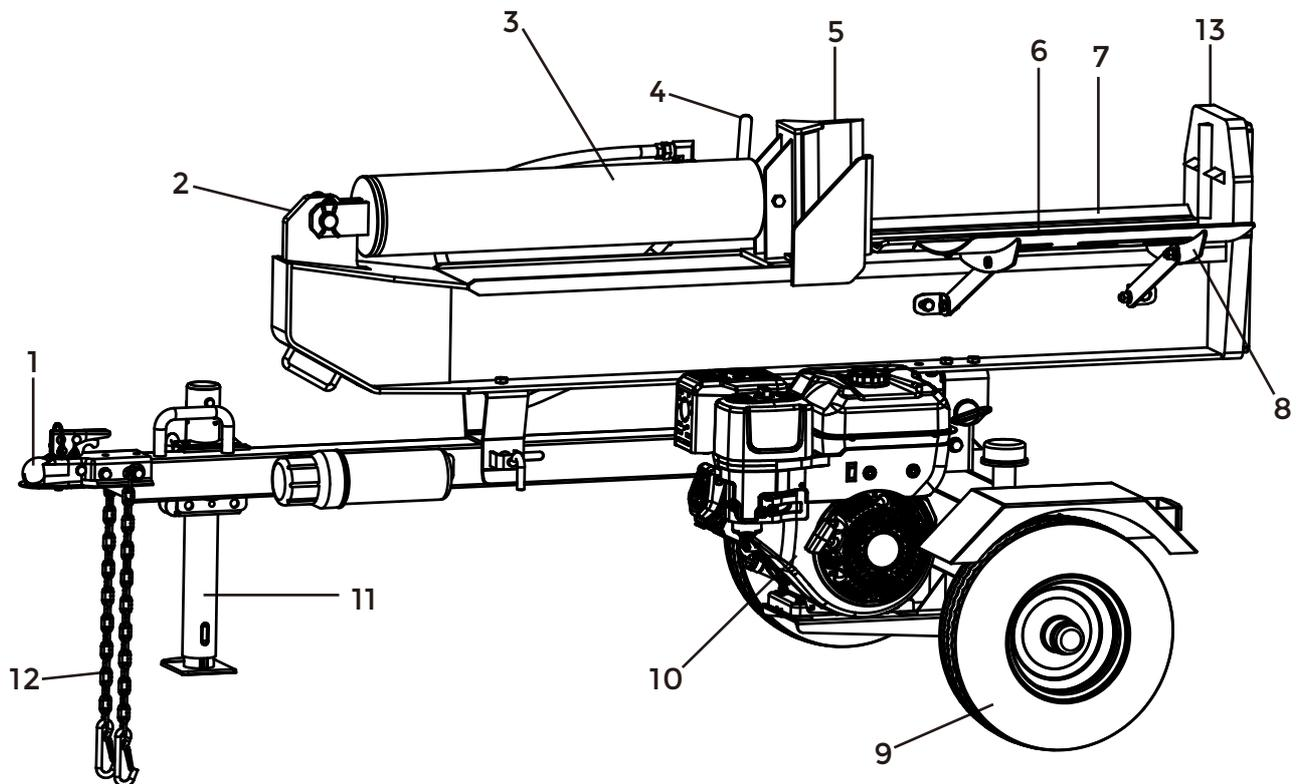
1. **Attelage à boule de 2 po (5,1 cm)** - Pour remorquer la fendeuse de bûches derrière votre véhicule.
