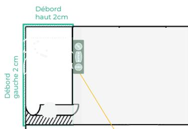
Contrôlez l'alignement vertical du 1er lé à l'aide d'un niveau à bulle ou d'un fil à plomb
