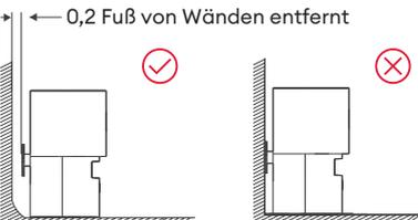
Diese Ladestation ist so konzipiert, dass sie automatisch Staub aufnimmt und den Roboter wieder auflädt. Stellen Sie die Ladestation auf eine flache, harte Oberfläche, mindestens 0,2 Fuß von Wänden entfernt. Stellen Sie sicher, dass vor und auf beiden Seiten der Ladestation freier Platz ist, damit Ihr Roboter zum Aufladen und Staubsammeln zur Ladestation zurückkehren kann.
