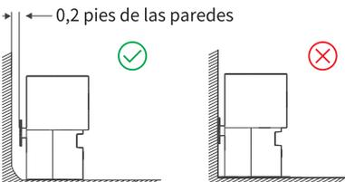
Esta estación de carga está diseñada para recolectar polvo y cargarse automáticamente para el robot. Coloque la estación de carga sobre una superficie plana y dura a una distancia mínima de 0,2 pies de las paredes. Asegúrese de que haya espacio libre al frente y a ambos lados de la estación de carga para que su robot pueda regresar a la estación de carga para cargarse y recolectar polvo.
