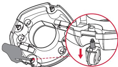
c. Saque la nueva rueda y alinee primero los dos extremos fijos de la rueda con el hueco bajo el chasis del robot. A continuación, presione suavemente y oirá un "clic" si la instalación se ha realizado correctamente.
