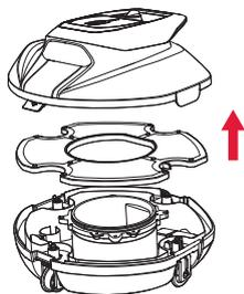
b. Con una herramienta o con los dedos, empuje suavemente hacia fuera, hacia la ranura, y saque el chasis del robot presionando sobre la parte superior de la rueda vieja.
