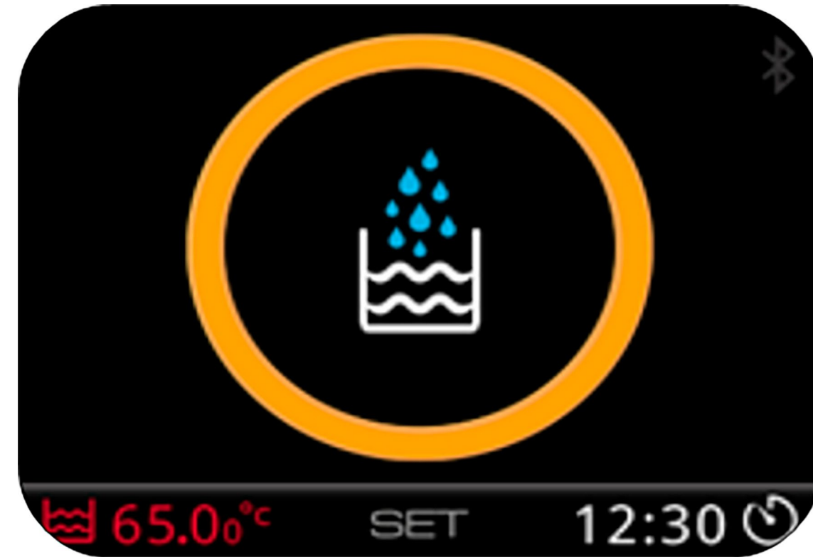
Falta de agua
