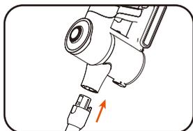
2. Inserire l'estremità della spina del tubo nell'ingresso dell'aria del pulitore. Quando è saldamente seduto, sentirai un suono "click".
