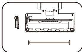
2. Rimuovere delicatamente la spazzola del rotolo e pulire o sostituire.
