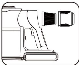
4. Se è necessario rimuovere il filtro di scarico, ruotare il coperchio del filtro in senso antiorario. Quindi, estrarre il filtro di scarico dal coperchio del filtro.
