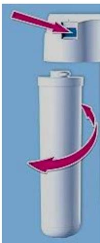
Der Filter wird zum Wechsel einfach zusammen mit dem Kopf aus dem Edelstahlfuß herausgezogen, der Verriegelungsstift hineingedrückt und mit einer 1/4 Drehung in den Kopf ein- oder ausgeklickt (Ausbau: gegen den Uhrzeigersinn drehen, Einbau mit dem Uhrzeigersinn drehen).
