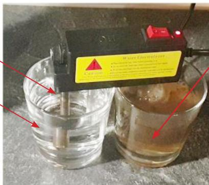
Wasser mit Mineralsalz Anteil oder mit Kochsalz: es fließt starker Strom von der Eisenelektrode (bräunlich) zur anderen Elektrode.
