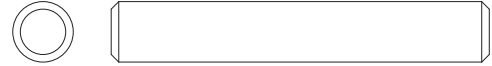
JJ \Phi 8 x 50mm Wood Dowel x4 Pasador de madera M8 x 50mm
