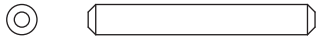
EE \Phi 4x30 mm Metal Pin x 4 Clavija metálica \Phi 4 x 30 mm x 4
