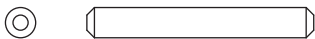
K \Phi 4x30 mm Metal Pin x 12 \Phi 4x30 mm Clavija metálica x 12 5493
