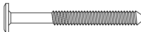
GG. M6 x 60 mm Bolt x 2 Boulon M6 x 60 mm x 2 Perno M6 x 60 mm x 2
