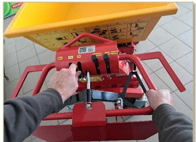
Pour basculer la charge, poussez la poignée de basculement vers le haut avec la main gauche, tout en gardant la main droite sur le guidon. La vitesse est déterminée par le guidon : plus vous appuyez dessus, plus vous vous déplacez rapidement.
