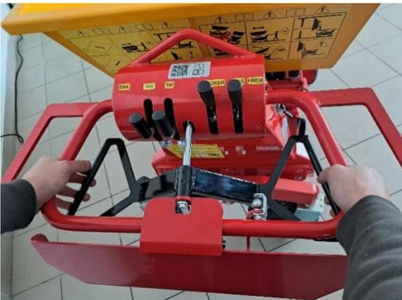
Placez les deux mains sur le guidon de manière à ce que les doigts puissent atteindre le manche de propulsion. Tirez sur le côté droit du manche pour faire avancer la machine. Relâchez le manche pour arrêter la machine. Tirez sur le côté gauche du manche pour faire reculer la machine.
