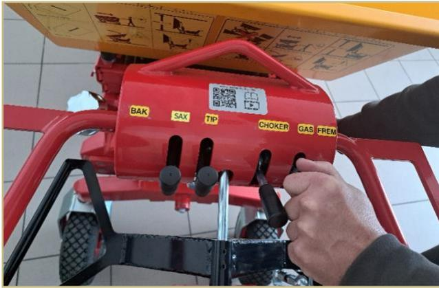
Démarrez la machine en activant le starter et en augmentant un peu le régime lorsque le moteur est froid. Ensuite, tournez la clé de contact dans le sens des aiguilles d'une montre. Lorsque le moteur tourne, relâchez la clé et réglez le starter jusqu'à ce que le moteur fonctionne correctement. Réglez le régime en fonction du nombre de tours moteur souhaités.
