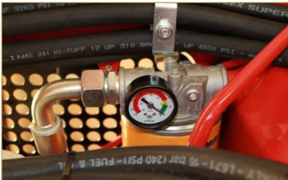
Le témoin sur le filtre hydraulique indique si le filtre doit être remplacé en plus de son remplacement lors d'un entretien périodique.
