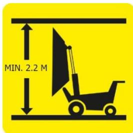
Les machines ne peuvent être transportées que par des moyens de transport disposant d'une garde au sol suffisante, car il existe un risque de blessures et d'endommagements graves pour les opérateurs, les machines et les moyens de transport.
