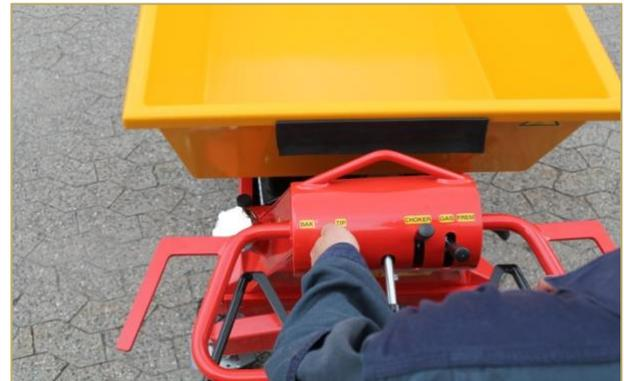
Pour basculer la charge, poussez la poignée de basculement vers le haut avec la main gauche, tout en gardant la main droite sur le guidon. La vitesse est déterminée par le guidon : plus vous appuyez dessus, plus vous vous déplacez rapidement.
