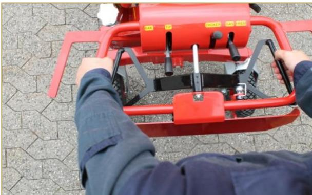
Placez les deux mains sur le guidon de manière à ce que les doigts puissent atteindre le manche de propulsion. Tirez sur le côté droit du manche pour faire avancer la machine. Relâchez le manche pour arrêter la machine. Tirez sur le côté gauche du manche pour faire reculer la machine.
