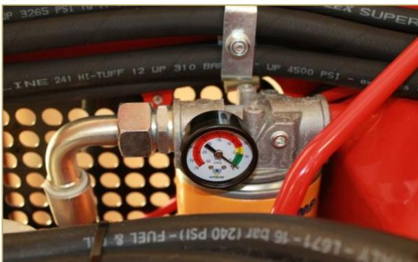
Le témoin sur le filtre hydraulique indique si le filtre doit être remplacé en plus de son remplacement lors d'un entretien périodique. Faites fonctionner le moteur à plein régime puis vérifiez le témoin. Si l'aiguille est dans la zone rouge, la machine doit être entretenue.
