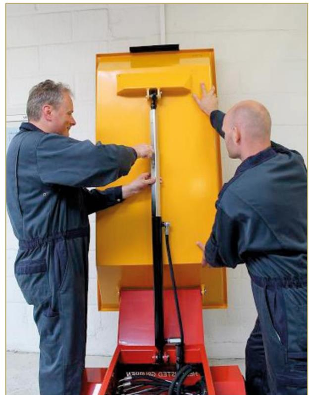
Pendant qu'une personne maintient la charge, l'autre personne installe le dispositif de sécurité sur le vérin hydraulique.
