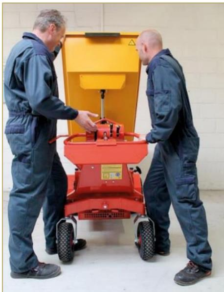
En cas de défaillance du moteur, la charge peut être basculée manuellement. Cette tâche nécessite deux personnes.
