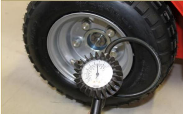
Pour des conditions ergonomiques optimales, tous les pneus doivent avoir une pression d'air correcte.
