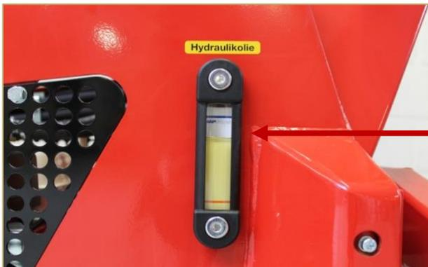
**AVERTISSEMENT !** Installez le dispositif de sécurité anti-basculement. Ajoutez de l'huile hydraulique de type Q8 Handel 46 ou équivalente.
