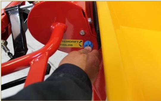
Le bouton de découplage est utilisé pour découpler les roues motrices afin de pouvoir déplacer la brouette à moteur avec le moteur arrêté. Tournez le bouton dans le sens inverse des aiguilles d'une montre pour découpler. Appuyez sur le bouton et tournez dans le sens des aiguilles d'une montre pour coupler le moteur à nouveau.
