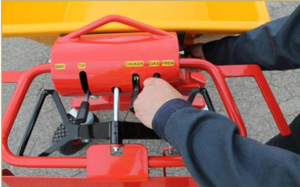
Démarrez la machine en activant le starter et en augmentant un peu le régime lorsque le moteur est froid. Ensuite, tournez la clé de contact dans le sens des aiguilles d'une montre. Lorsque le moteur tourne, relâchez la clé et réglez le starter jusqu'à ce que le moteur fonctionne correctement. Réglez le régime en fonction du nombre de tours moteur souhaités.
