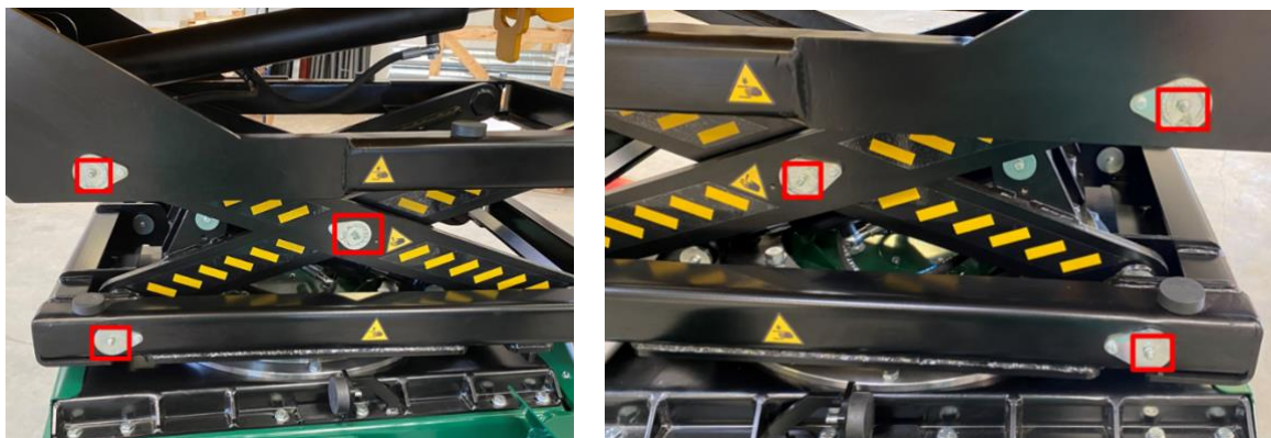
Figur 77: Smørenipler på højre og venstre side af saxearme
