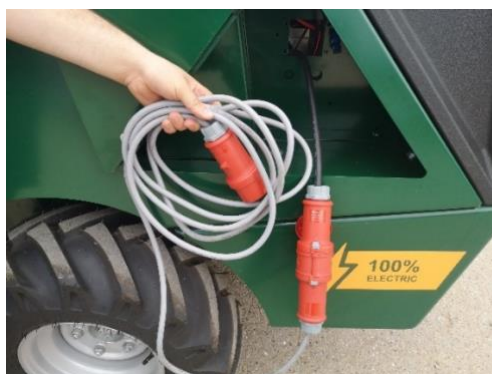
Figur 54: Lade kabel med forlænger
