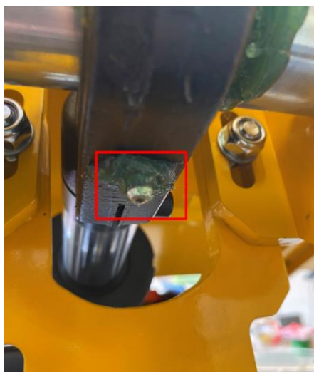
Figur 75: Smørenippel under container ved rotationslås
