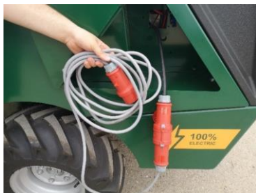
Figur 54: Lade kabel med forlænger
