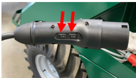
Figur 57: Kontakter på lader
