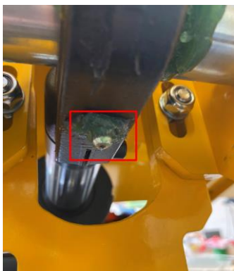
Figur 75: Smørenippel under container ved rotationslås
