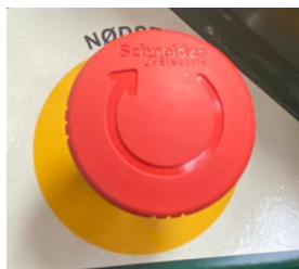
Figur 70: Drejning af nødstop
