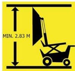
N'utilisez pas le dumper si la hauteur sous plafond est insuffisante.
