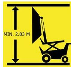
Les machines ne peuvent être transportées que par des moyens de transport disposant d'une garde au sol suffisante, car il existe un risque de blessures et d'endommagements graves pour les opérateurs, les machines et les moyens de transport.
