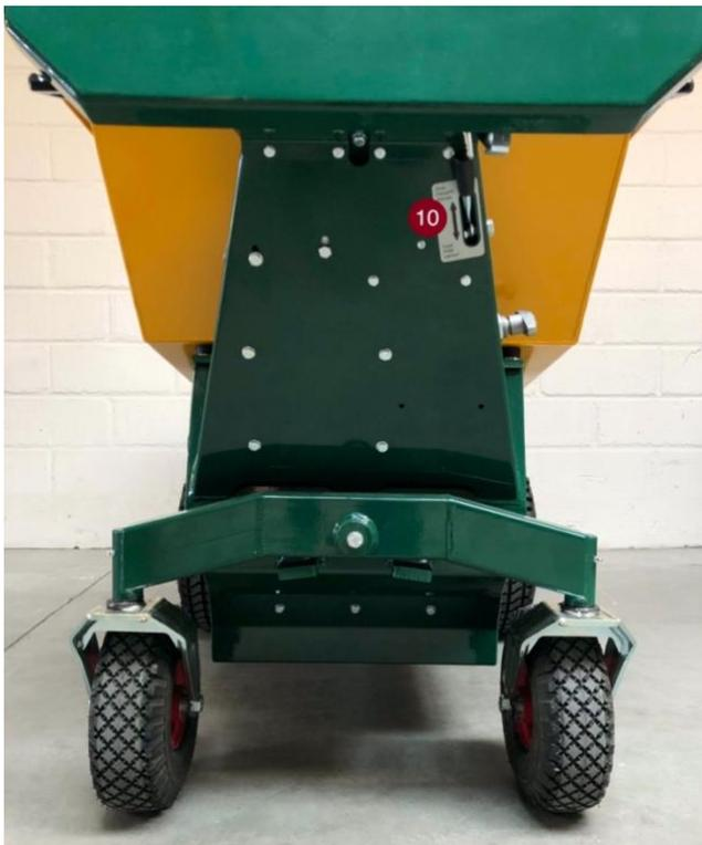
Lors du levage de la machine, utilisez les trois points d'ancrage à l'avant et sur le tableau de bord. L'ancrage doit être suffisamment stable pour éviter tout décrochage.
