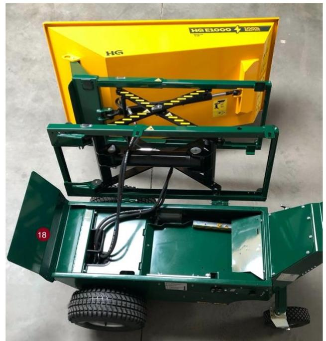
Retirez ensuite la plaque supérieure du compartiment à batterie en soulevant à travers l'orifice allongé. La plaque est maintenue en place par des aimants. Voir figure (19)
