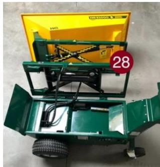
**REMARQUE :** Dans ce cas, veillez à ce que la benne soit basculée d'au moins 125° (degrés) au-dessus de la surface horizontale où la benne est en position normale, pour éviter notamment que la benne retombe.
