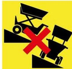
NE conduisez JAMAIS sur des pentes avec une benne vide ou pleine lorsque la fonction HIGH TIP est activée.
