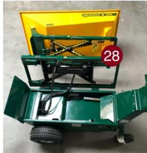
Si le HIGH TIP n'est pas relevé, la benne doit, lorsqu'elle est basculée sur le côté, être soutenue par un objet stable et adapté, comme un arc de support d'une capacité de charge approuvée d'au moins 200 kg. Voir figure (25).
