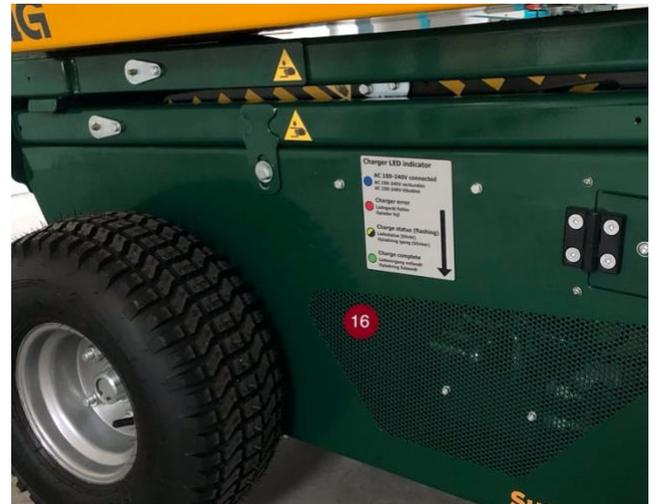
4) Lorsque la machine est complètement chargée, le voyant vert du chargeur reste allumé. Débranchez ensuite la prise de l'alimentation secteur et enroulez le câble de charge autour des crochets sur la trappe de la batterie. Fermez ensuite la trappe, voir figure (13).
