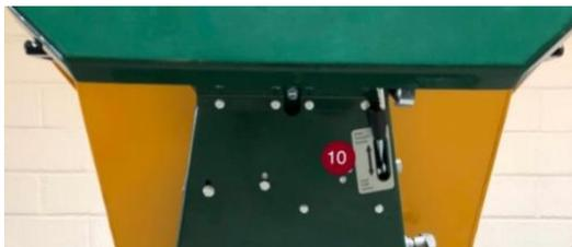
**Interrupteur principal** illustré en mode « Interrompu ». Lorsque vous utilisez la machine, tournez l'interrupteur principal de 90°
