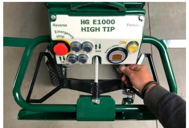
Tournez l'interrupteur principal sur la position indiquée pour couper le courant entre la batterie et les autres composants électriques de la machine.
