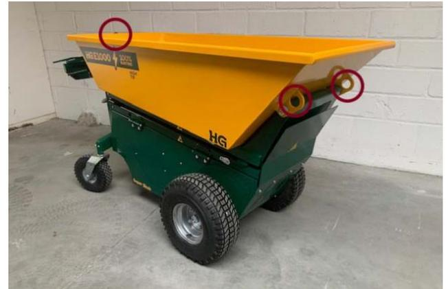
Le levage de la machine peut être effectué **UNIQUEMENT** avec une charge vide. N'utilisez **JAMAIS** la poignée de commande ou les plaques de sécurité ou tout autre équipement autour du tableau de bord pour sécuriser la machine.
