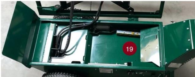
Séparez le connecteur bleu de la batterie composé de deux parties homologues. Voir figure (20). Une fois les deux parties homologues bleues et le connecteur COM gris séparés, la plaque supérieure du compartiment à batterie peut être réinstallée et la benne peut être remise en place.
