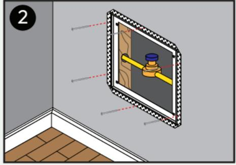
2 Ensure flange is flat to the wall. Use drywall screws to fasten. / S'assurer que la bride est bien à plat contre le mur. Utiliser des vis pour cloisons sèches pour la fixation.
