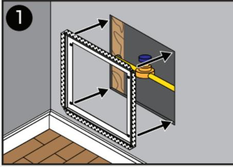
1 Locate studs behind drywall and cut a hole. Dry-fit **Body** into opening. / Localisez les montants derrière la cloison sèche et découpez un trou. Fixer le **Corps** à sec dans l'ouverture.
