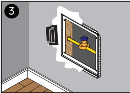
3 Use mud to cover flange surface. Wait to dry, then sand. Repeat as needed. / Utiliser de la boue pour cloisons sèches pour couvrir la surface de la bride. Attendre le séchage, puis poncer. Répéter l'opération si nécessaire.
