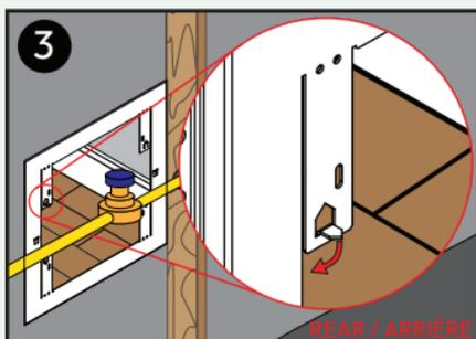
Bend all four small tabs 90 degrees towards the wall cavity. / Pliez les quatre petites languettes à 90 degrés vers l'ouverture du mur.
