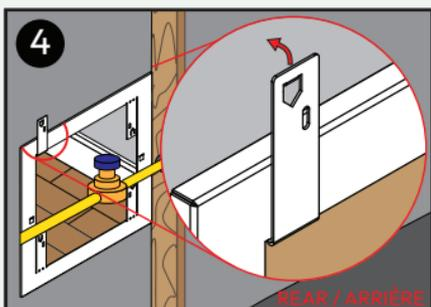
Bend large tabs 180 degrees so the small tabs puncture the wall. / Pliez les grandes languettes à 180 degrés de manière à ce que les petites languettes perforent le mur.
