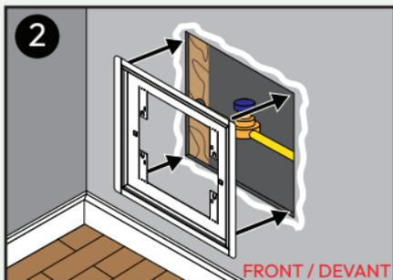
Dry-fit **Body** into opening. Fixer le **Corps** à sec dans l'ouverture.
