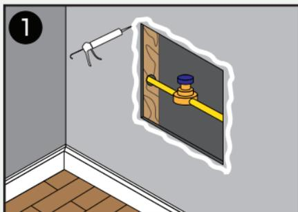
Locate studs behind drywall and cut a hole. Apply adhesive around the perimeter of the opening. / Localisez les montants derrière la cloison sèche et découpez un trou. Appliquez l'adhésif sur le périmètre de l'ouverture de la cloison sèche.
